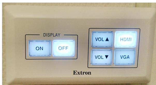
4 – Sélectionnez la source HDMI, VGA sur le boîtier mural selon le câble de raccordement utilisé
