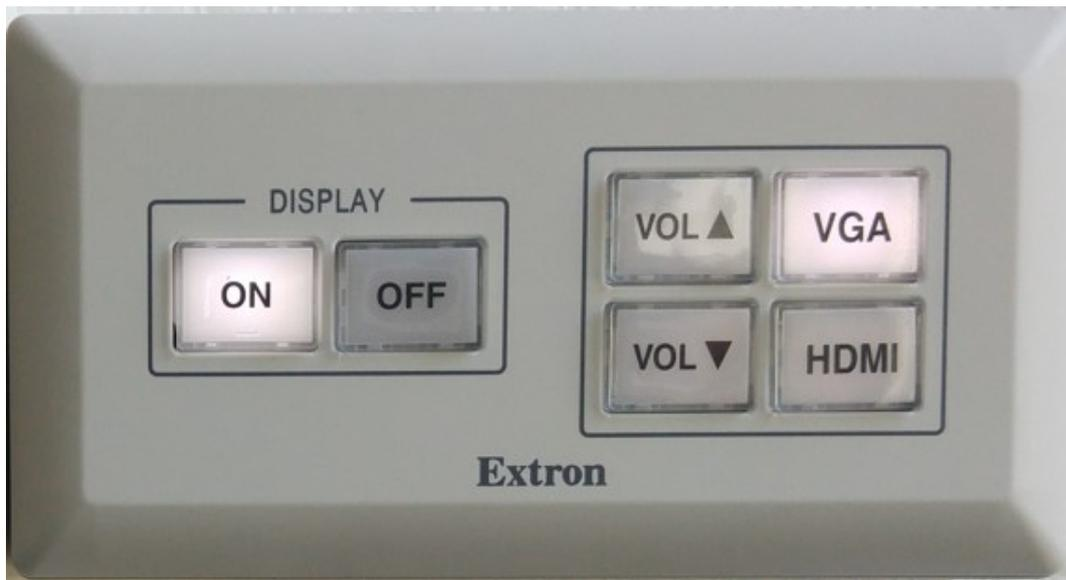
3 – **Sélectionnez la source HDMI, VGA** sur le boîtier mural selon le câble de raccordement utilisé
